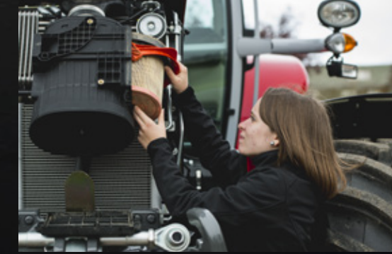
Motor hava filtresinin erişimi ve temizliği çok kolaydır.
