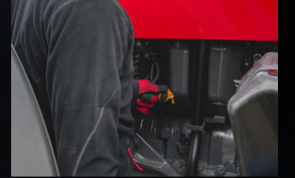
Ön aks ve ince belli kaporta tasarımı yağ çubuğu ve filtresine erişimi kolaylaştırır.
