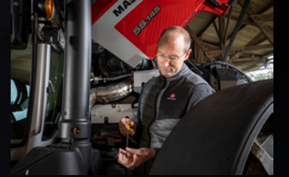
Ön aks ve ince belli kaporta tasarımı yağ çubuğu ve filtresine erişimi kolaylaştırmaktadır.
