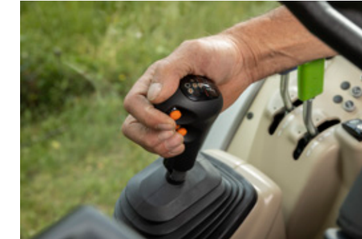
▲ Sorunsuz bir çalışma için bowden kablolu yeni vites kolu.
